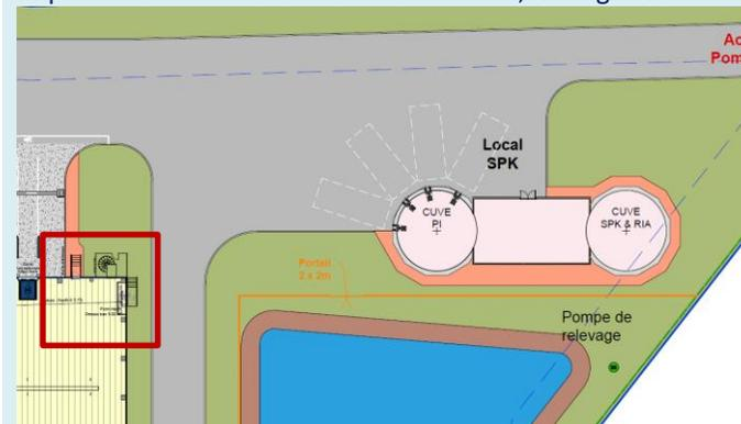
La vanne en aval du bassin est la pompe de relevage qui permet de mettre en rétention les eaux et qui est asservie au déclenchement de l'extinction automatique incendie. Cette vanne était déjà indiquée dans le plan masse réseau et a été ajoutée dans le plan de masse.
